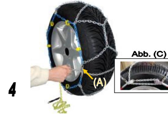
**4** Eine ¼ Radumdrehung vor oder zurück fahren, bis sich der Verschluss (siehe Abb. A) in Achshöhe befindet. Spannkette kräftig anziehen, so dass sich die Bügelenden hinter dem Reifen zusammenziehen (siehe Abb. C).
