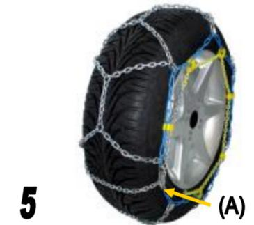
**5** Spannkette im Schlitz der Verschlussplatte (siehe Abb. A) einrasten und in Schlitzrichtung durch die Führungsösen ziehen – Endhaken einhängen.
