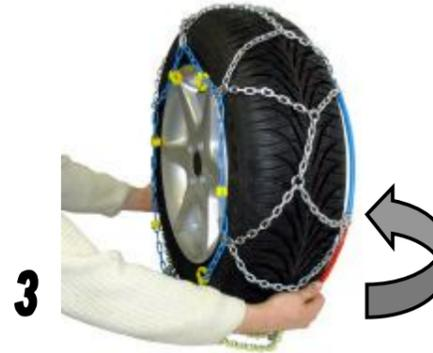
**3** Bügelenden hinter den Reifen schieben, so dass Bügel zusammen federt.
