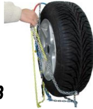
3 Bügelenden erfassen und über den Reifen ziehen – wenn Kette auf der Fahrbahn liegt, ausfahren.
